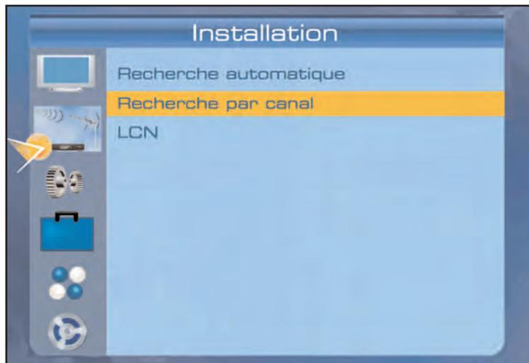
Avec les touches CH+/CH- aller sur Recherche par canal et presser sur la touche OK.
