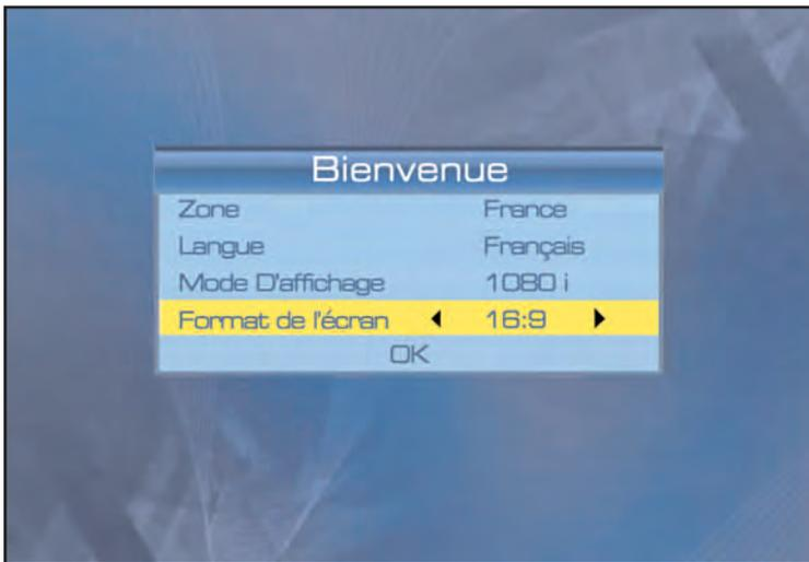
Avec les touches CH+/CH- et VOL+/VOL- sélectionner les fonctions et modifier les paramètres, puis aller sur OK avec la touche CH- et presser sur la touche OK de la télécommande pour démarrer la recherche des chaînes.
