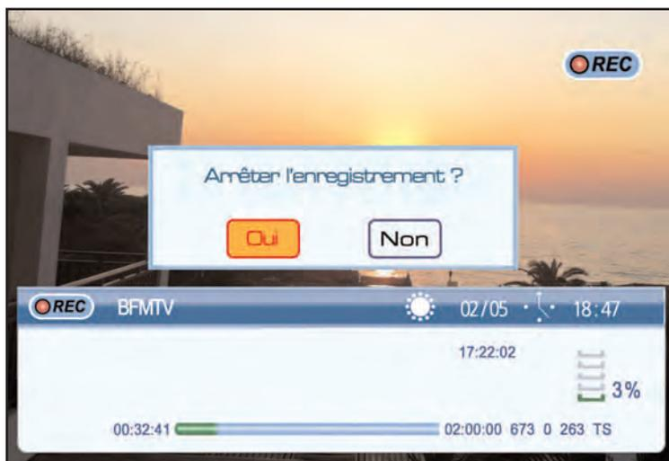
Pour stopper un enregistrement presser une fois sur la touche STOP de la télécommande pour afficher la fenêtre de dialogue permettant de le stopper.
