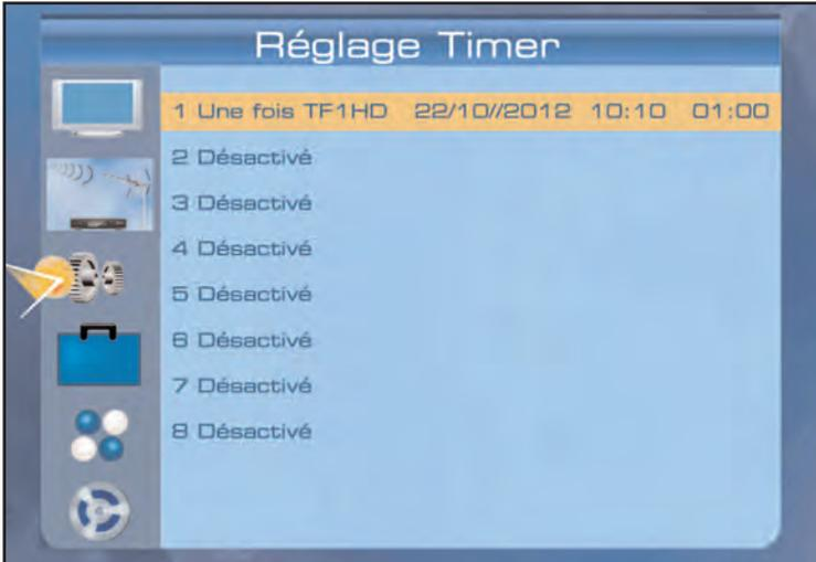
Presser sur la touche MENU de la télécommande. Avec les touches CH+/CH- positionner la flèche sur l'icône figurant le système, puis avec les touches VOL+/VOL- et CH+/CH- aller sur Réglages Timer et presser sur la touche OK de la télécommande pour ouvrir le menu.
