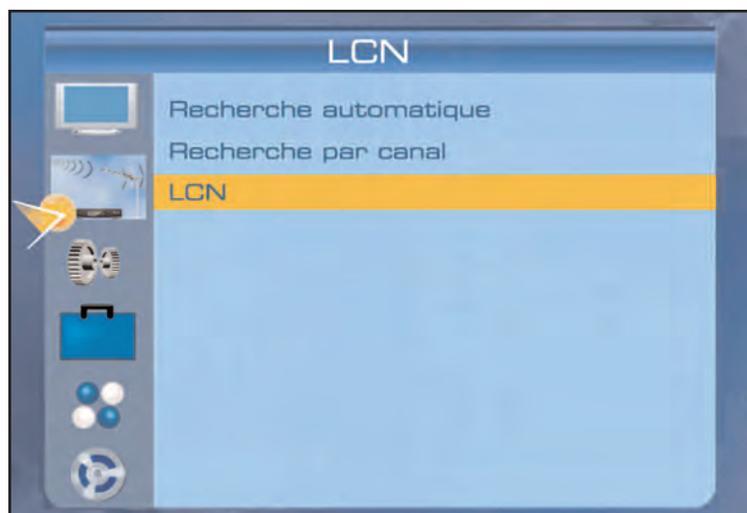
Avec les touches CH+/CH- positionner la flèche sur l'icône Installation puis avec les touches VOL+/VOL- puis CH+/CH- aller sur LCN et presser sur la touche OK pour accéder au menu.
