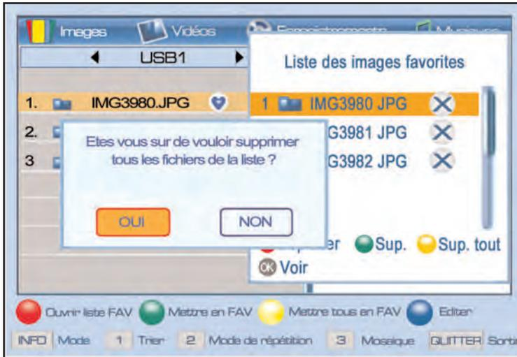
Pour supprimer une image, la sélectionner avec les touches CH+/CH-, presser sur la touche verte, choisir OUI avec les touches VOL+/VOL- et presser sur la touche OK.
