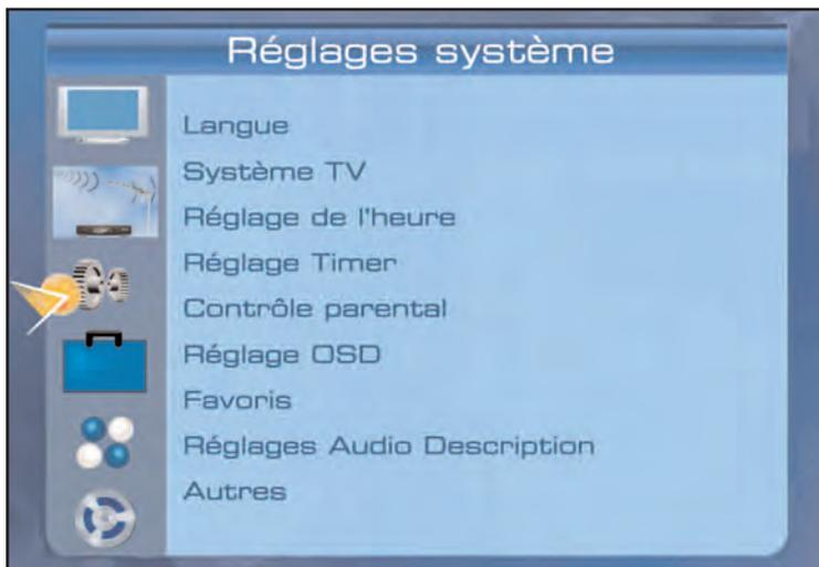
Avec les touches CH+/CH- positionner la flèche sur l'icône Réglages Système puis presser sur la touche OK de la télécommande pour accéder au menu.
