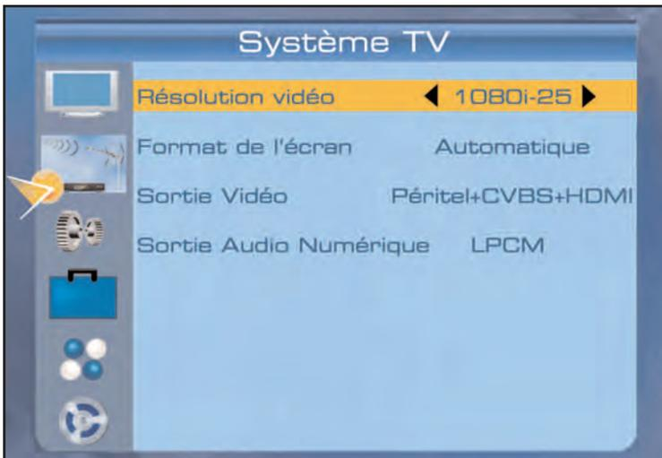
Ce menu permet de paramétrer la résolution vidéo, le format d'écran, la sortie vidéo, et la sortie audio numérique.
