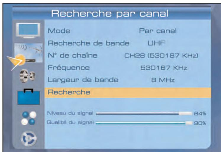
Ce menu permet d'effectuer une recherche des chaînes par canal ou par fréquence.
