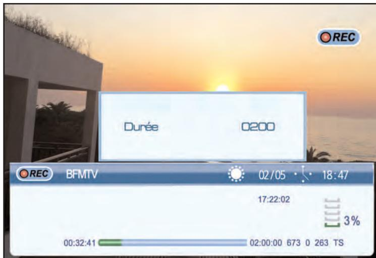
Durant un enregistrement une double pression sur la touche ENREGISTRER de la télécommande fait apparaître sur l'écran un bandeau permettant de paramétrer la durée de l'enregistrement.
