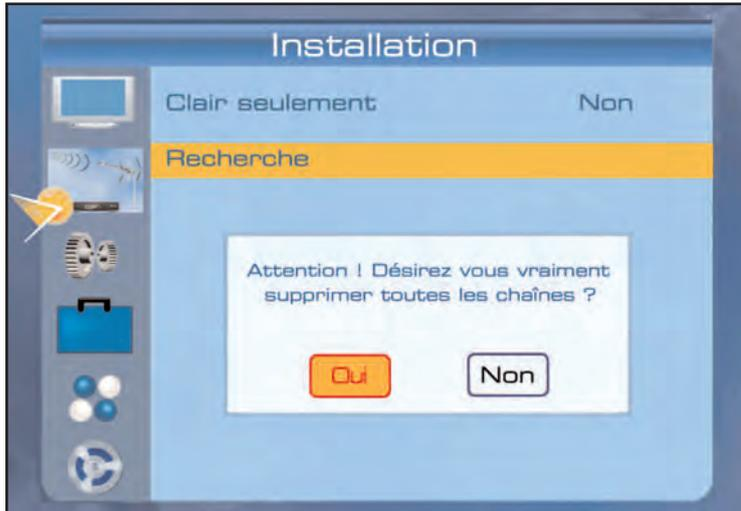
Avec les touches CH+/CH- aller sur Recherche et presser sur la touche OK de la télécommande.
