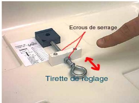
Réglage de l'angle d'élévation :
