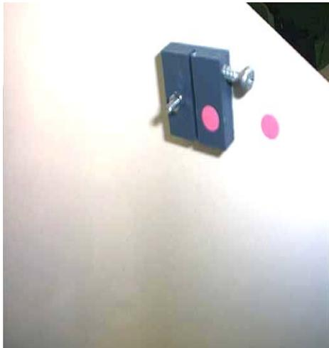
Positionnez les taquets latéraux avec les 2 vis de 25mm de long et de 3mm de Ø et 1 écrou de 3mm par taquet. Bloquez modérément en ajoutant le 2ème écrou sur chaque taquet la fente doit être visible (voir photo)
