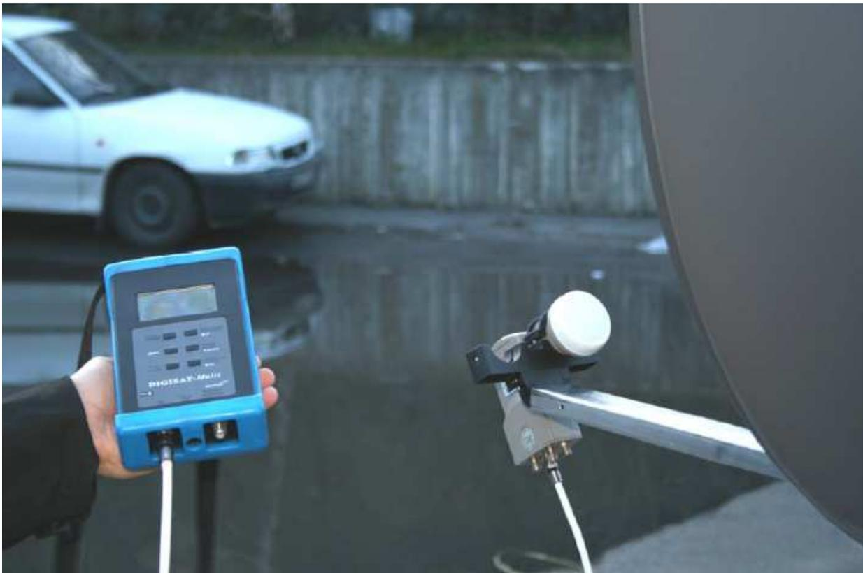
La photo ci-dessus montre le mètre faisant fonctionner l'assemblée LNB avec l'alimentation électrique interne. Pour utiliser le récepteur satellite pour le pouvoir, connectez le port de droite sur le compteur (étiqueté «receveur») au receveur "Sat Input".
