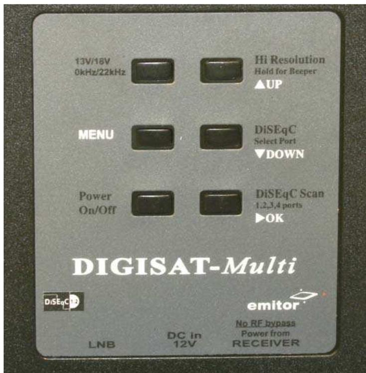
Appuyez sur le bouton «Hi Resolution » si vous voulez "zoomer" sur un signal (La barre devient plus dynamique, par rapport à cela a affiché des mouvements de force de signal).
