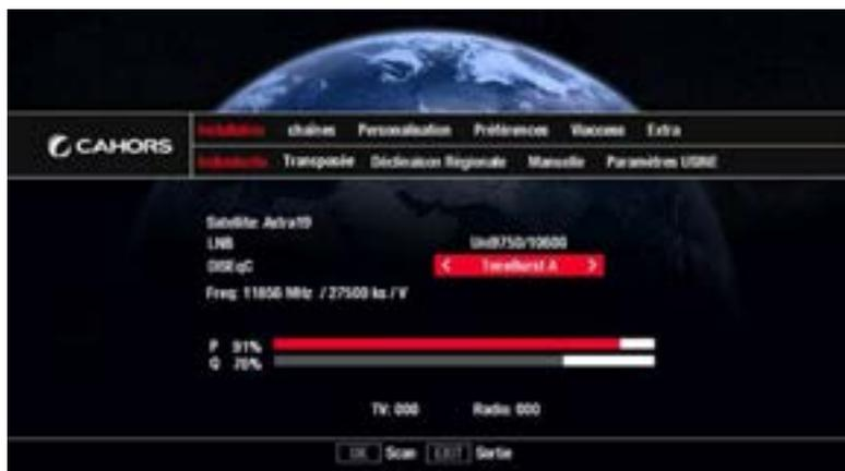
Votre parabole doit être pointée vers le satellite Astra19. Si votre antenne dispose de plusieurs LNB, vous pouvez sélectionner l'entrée du commutateur sur lequel est connecté Astra 19 avec le réglage DISEqC. La barre P indique la puissance du signal, tandis que la barre « Q » indique sa qualité.
