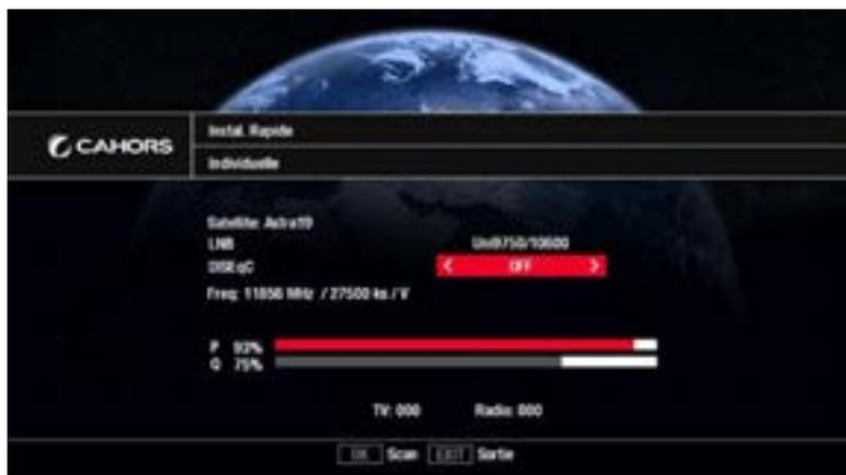
Votre antenne parabolique doit être dirigée vers le satellite Astra 19.2°E. Si tel n'est pas le cas, régler progressivement l'antenne parabolique de manière à faire monter la barre de puissance au maximum. La barre de qualité doit être au minimum à 60%. Si votre antenne possède plusieurs LNB, il est possible de choisir celui correspondant grâce à la commande DiSEqC.
