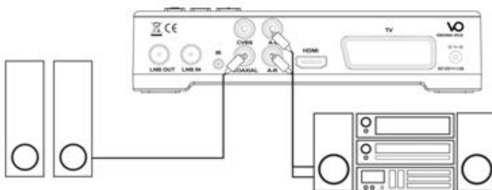
Pour bénéficier du son stéréo sur votre chaîne Hi-fi, raccordez les sorties audio analogiques droite et gauche de votre terminal aux entrées gauche et droite auxiliaires de votre amplificateur Hi-fi. Si votre amplificateur dispose d'une entrée audio numérique coaxiale SPDIF, vous pouvez la raccorder à la prise coaxiale pour profiter d'une qualité sonore supérieure.
