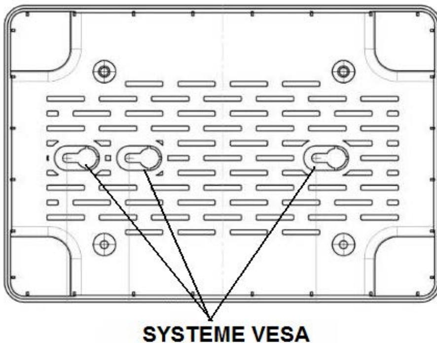
Le système VESA permet la fixation du terminal à l'arrière d'un téléviseur en pointant la connectique vers le haut, le bas ou sur le côté avec le tuner en haut, selon la disposition de la connectique du téléviseur.
