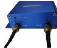
Connectez l'antenne GSM à l'unité.
