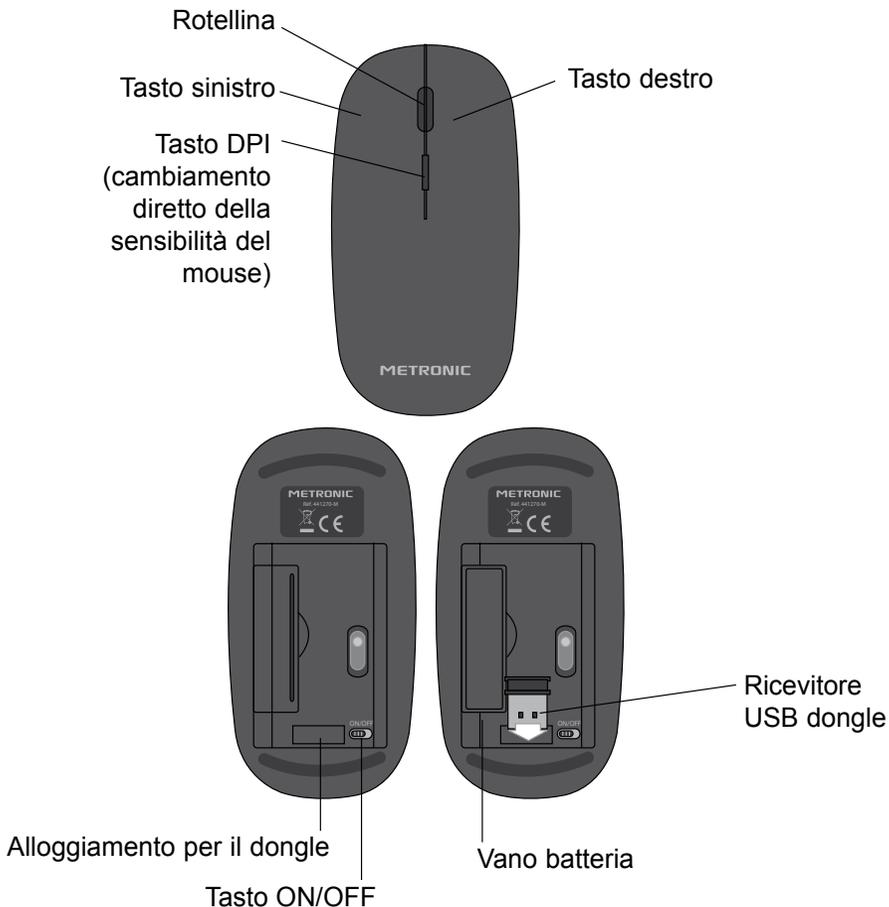
Per un funzionamento ottimale del mouse, evitare di utilizzare su una superficie di vetro, luminosa o troppo scura. Il sensore ottico potrebbe non orientarsi correttamente.
