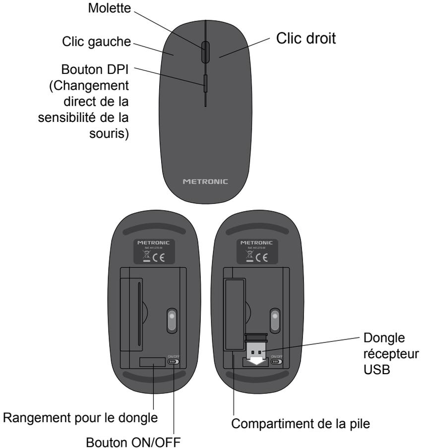
Pour un fonctionnement optimal de la souris, éviter de l'utiliser sur une surface en verre, brillante ou trop sombre. Le capteur optique aurait du mal à se repérer.
