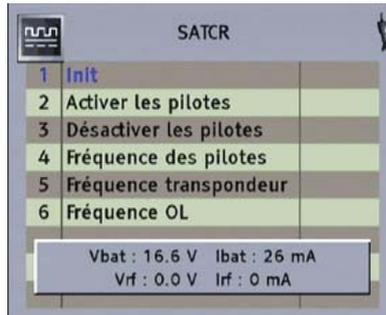
L'option "**Init**" force le démarrage du processus d'identification des prestations de la LNC.
