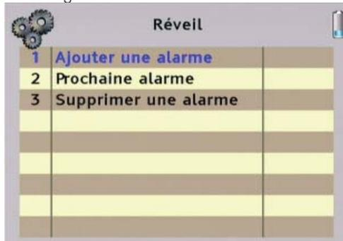
1. Ajouter une alarme : cette option vous permet de créer de nouvelles alarmes de réveil du mesureur. Vous pouvez choisir la date et l'heure de mise en marche, ainsi que l'action à réaliser lors du réveil (Enregistreur (Datalogger) ou aucune action).
