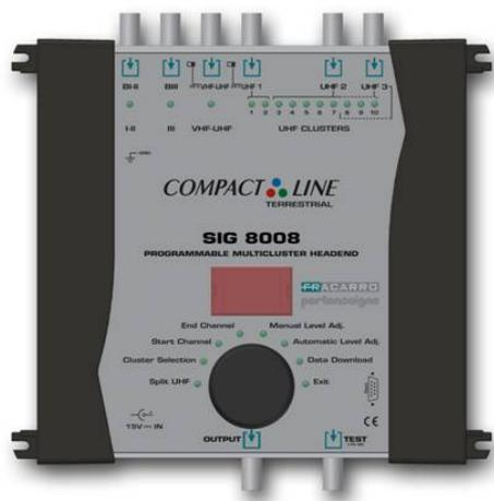
La station de tête multicanaux permet de filtrer à la fois les canaux analogiques et numériques. Composée de 10 groupes programmables, elle filtre tous les canaux de la bande UHF. Chaque groupe peut filtrer d'un à sept canaux adjacents. 3 entrées UHF, une entrée bande 1+FM, une entrée bande 3, 1 entrée DAB, 1 entrée VHF+UHF pour regrouper les signaux vers une sortie unique.
