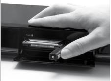
Refermez la trappe puis la façade. C'est en refermant la trappe que le disque va s'enfoncer complètement, et se connecter au magnétoscope. Poussez sur **ON** l'interrupteur de la face arrière.
