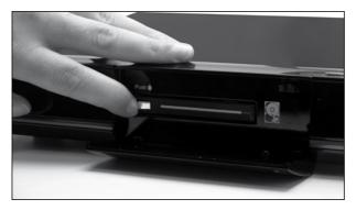
La trappe ouverte, insérez le disque dur doucement, les connecteurs vers le fond et le capot métallique du disque dur vers le haut.
