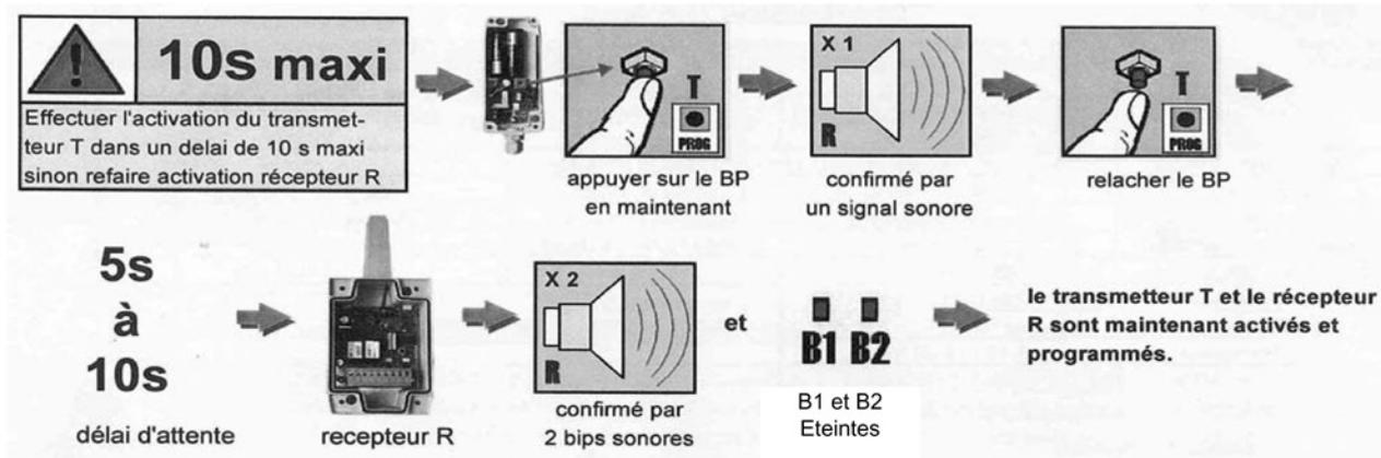
Pour vérifier le bon fonctionnement du système, il suffit d'appuyer sur vos profils palpeurs (détection d'obstacle) la Led B1 du récepteur doit s'allumer et votre armoire vous indiquera un défaut sécurité la Led B2 du récepteur doit s'allumer et votre armoire vous indiquera un défaut sécurité
