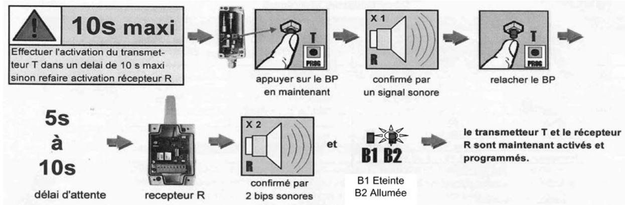
Pour vérifier le bon fonctionnement du système, il suffit d'appuyer sur votre profil palpeur (détection d'obstacle) la Led B1 du récepteur doit s'allumer et votre armoire vous indiquera un défaut sécurité
