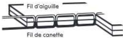
Si la tension du fil d'aiguille est trop serrée, le fil de la canette apparaît sur le côté droit du tissu. Diminuez légèrement la tension du fil pour résoudre le problème.
