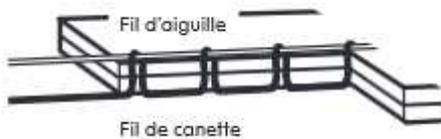
Si la tension du fil d'aiguille est trop lâche, celui-ci apparaît sur l'envers du tissu. Augmentez légèrement la tension du fil.
