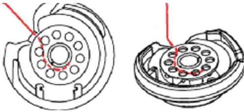
Tournez le volant vers vous (en sens inverse des aiguilles d'une montre) afin d'abaisser l'aiguille et de la relever (6).
