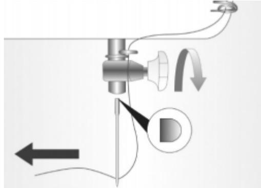
Serrez la vis de l'aiguille au maximum.
