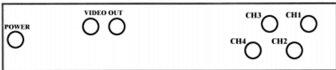
BNC CONNECTORS (CH1-CH4) : ingangsaansluitingen voor videosignaal
