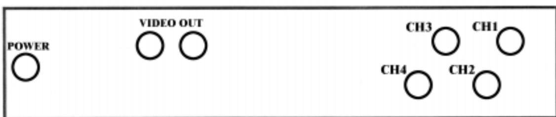
CONNECTEURS BNC (CH1-CH4) : connexions d'entrée pour signal vidéo
