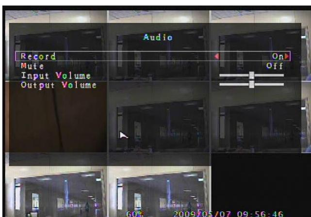
Si "Record" est sur "ON", le canal audio peut être enregistré. Si "Record" est sur "OFF", le canal audio ne peut pas être enregistré.
