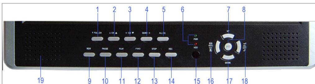
Une série de boutons situés sur la face avant de l'enregistreur numérique permet au système d'activer ses fonctions de base comme l'enregistrement, la lecture, l'avance et le retour rapides, etc. Pour plus de détails au sujet du menu de l'enregistreur numérique, consultez "[6. ENREGISTREMENT](#)".
