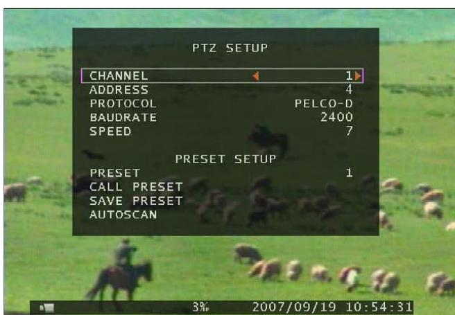
Un diagramme s'affiche à gauche. Par exemple, nous sélectionnons le canal 1. L'adresse du dôme est 4. Protocole utilisé **PELCO-D**. Le débit en bauds est de 2400 et la vitesse du dôme est 7.
