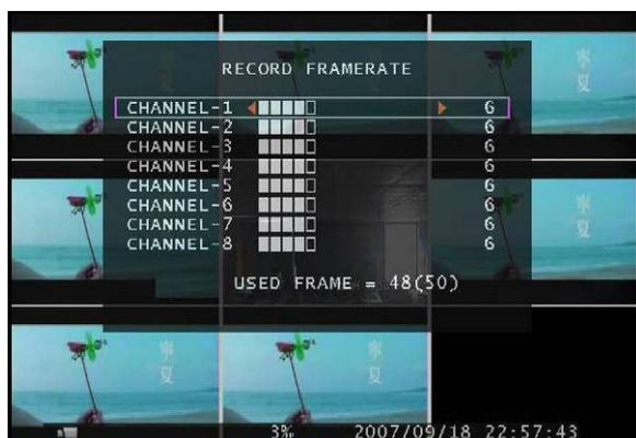
La vitesse d'enregistrement aura un effet sur le mouvement de l'objet dans la vidéo enregistrée. Plus il y a d'images, moins le mouvement sera saccadé mais plus l'enregistrement nécessitera d'espace sur le disque dur. Il est possible de régler indépendamment la vitesse d'enregistrement de chaque canal.
